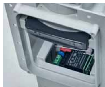
Récepteur installé dans le compartiment de la contre-prise du système Sense
