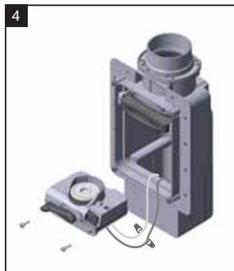
Das Mikrokabel der Absauganlage durch die vorgebohrten Löcher im Deckel führen.
