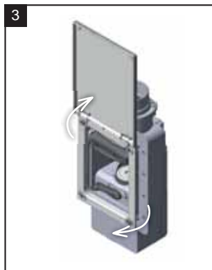
Vor dem Festziehen der Schrauben die Positionierung der Klappe einstellen
