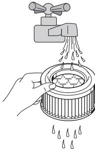
ACHTUNG: Bevor der Filter wieder eingesetzt wird muss dieser komplett getrocknet sein.
