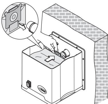
Montieren Sie wieder den Deckel, indem Sie sich versichern, dass die Fassung des Deckels genau auf den Körper der Zentrale gesetzt worden ist.
