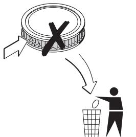
**2** Sollte die Filterkartusche Risse aufweisen, darf diese nicht mehr verwendet werden.
