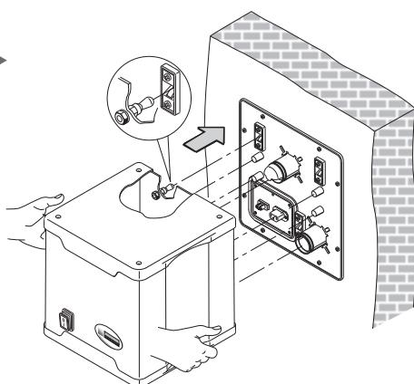
• 4.10 Abmontieren der Zentrale von der Einbauschablone
