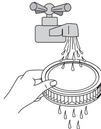
**ACHTUNG:** Bevor der Filter wieder eingesetzt wird muss dieser komplett getrocknet sein.
